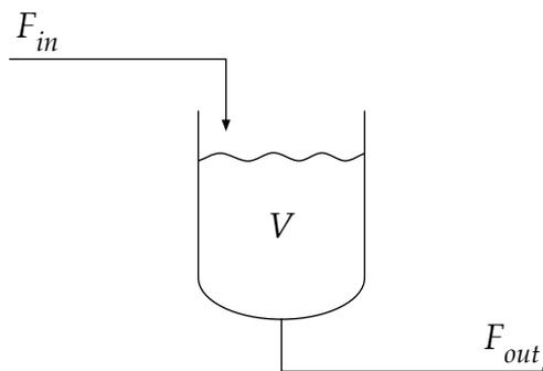
Figura 1.1: Depósito con salida por gravedad.
