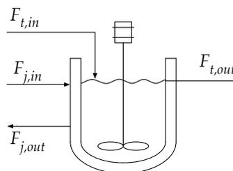
Figura 3.1: Tanque calentado mediante camisa.
