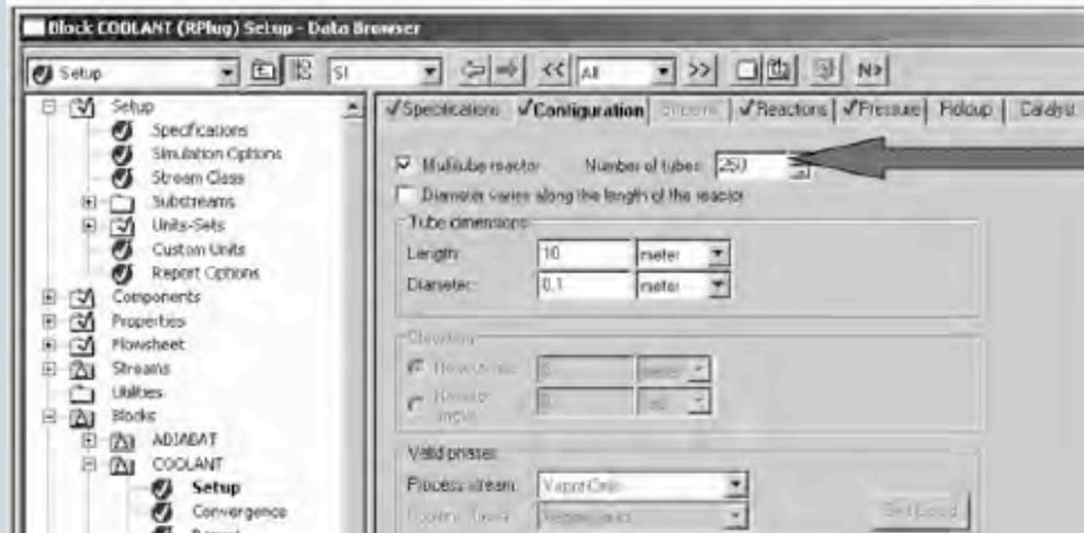
3b. Definir el tipo de reactor flujo tubular y poner las condiciones de operación (caso contracorriente el refrigerante)
