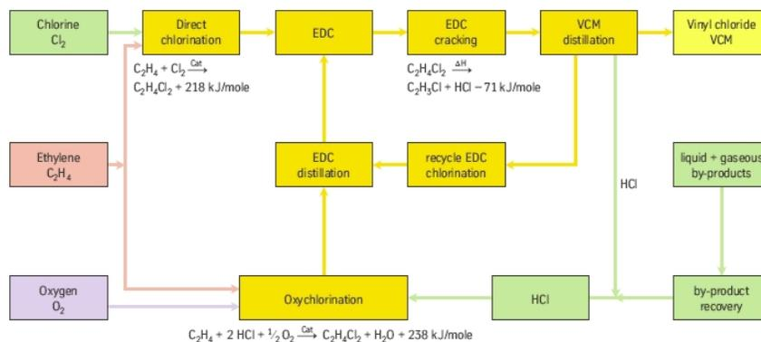
Figura 1: Diagrama de bloques del proceso de fabricación de VCM
