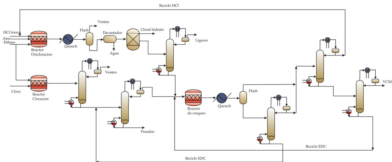
Figura 2: Proceso de fabricación de VCM
